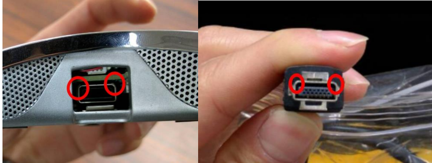
圖為麥克風端口與線材方向，主機與麥克風兩端均須確認。
